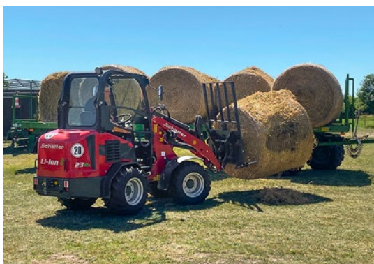
△ Der 23e von Schaeffer kann mit einer Akkuladung bis zu sieben Stunden am Stück arbeiten.
