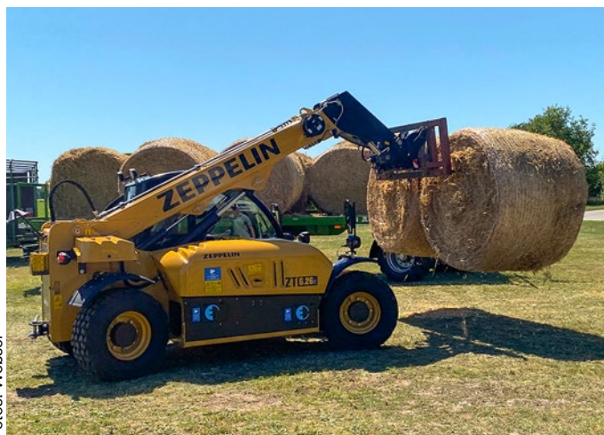
△ Hydraulik- und Fahrtrieb werden von zwei eigenständigen Elektromotoren versorgt.
