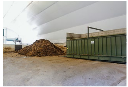
△ Der Feststoffdosierer steht in einem überdachten ehemaligen Maissilo.
