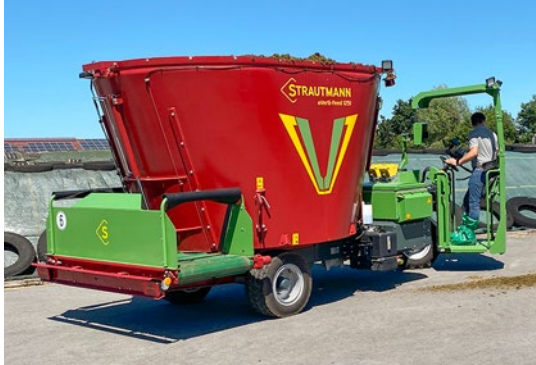
△ Der eVerti-Feed 1251 benötigt zum Mischen einer Tonne Futter ca. 3 kWh Strom.
