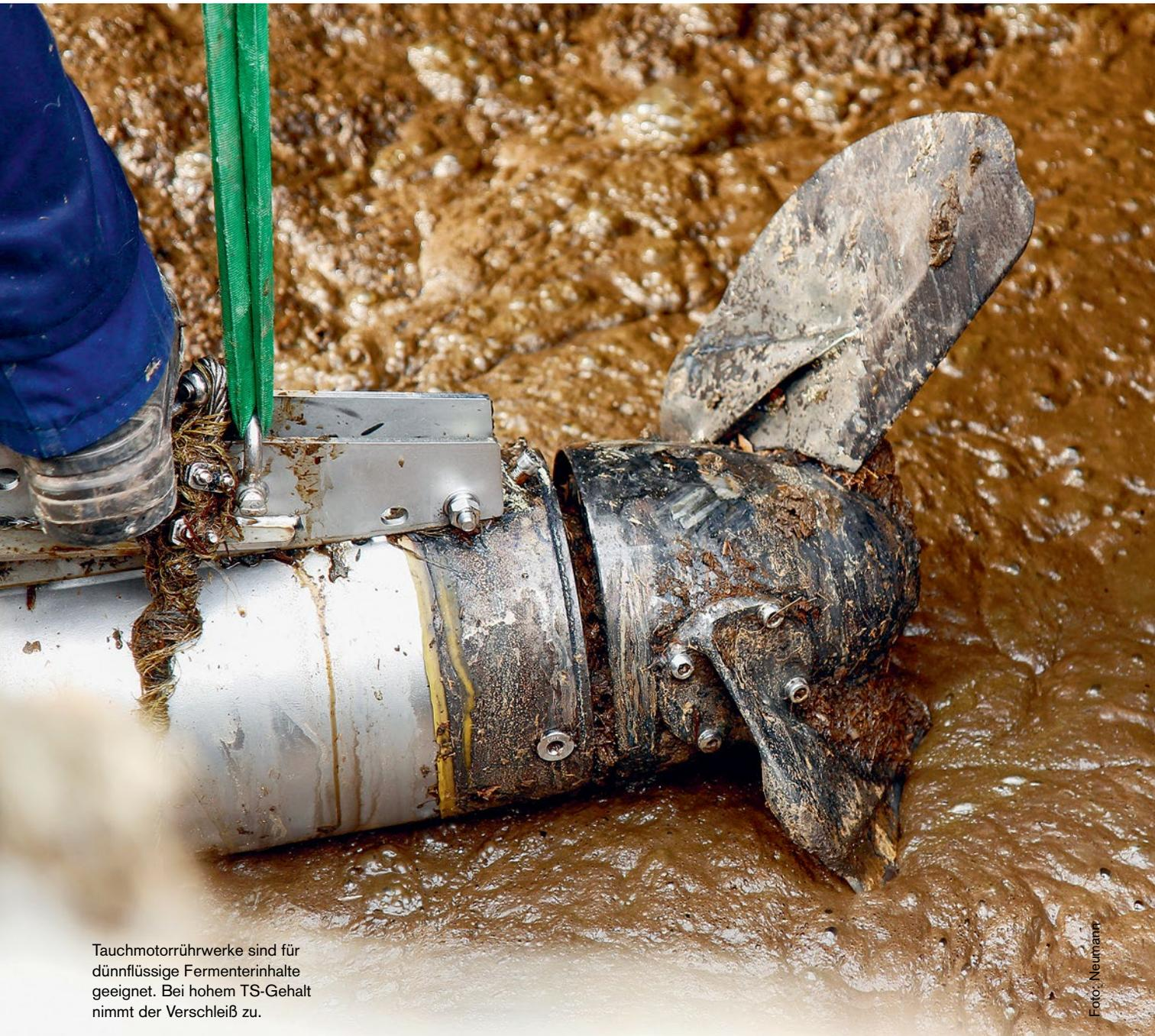
Tauchmotorrührwerke sind für dünnflüssige Fermenterenthalte geeignet. Bei hohem TS-Gehalt nimmt der Verschleiß zu.
