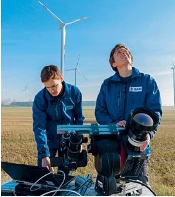
△ Mit einer Wärmebildkamera lassen sich frühzeitig Materialschwächen an einem Rotorblatt erkennen.
