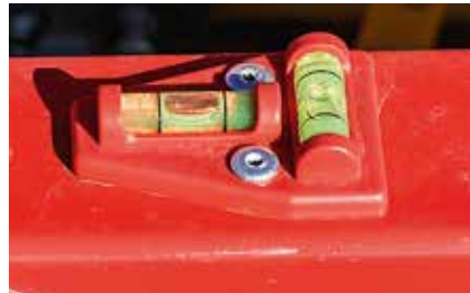
Schönes Detail: Auf ebenem Untergrund helfen die Libellen bei der Ausrichtung des Striegels.
